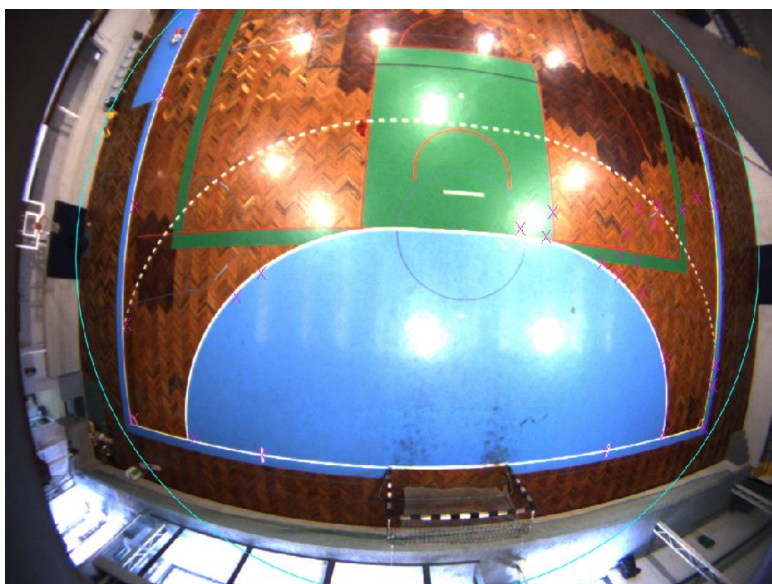
Figuras 4.11 – Aplicação do filtro para Pontos provenientes da função cvGoodFeaturesToTrack sendo identificados como “X” e a rosa. Circulo a azul turquesa do maior contorno envolvente
