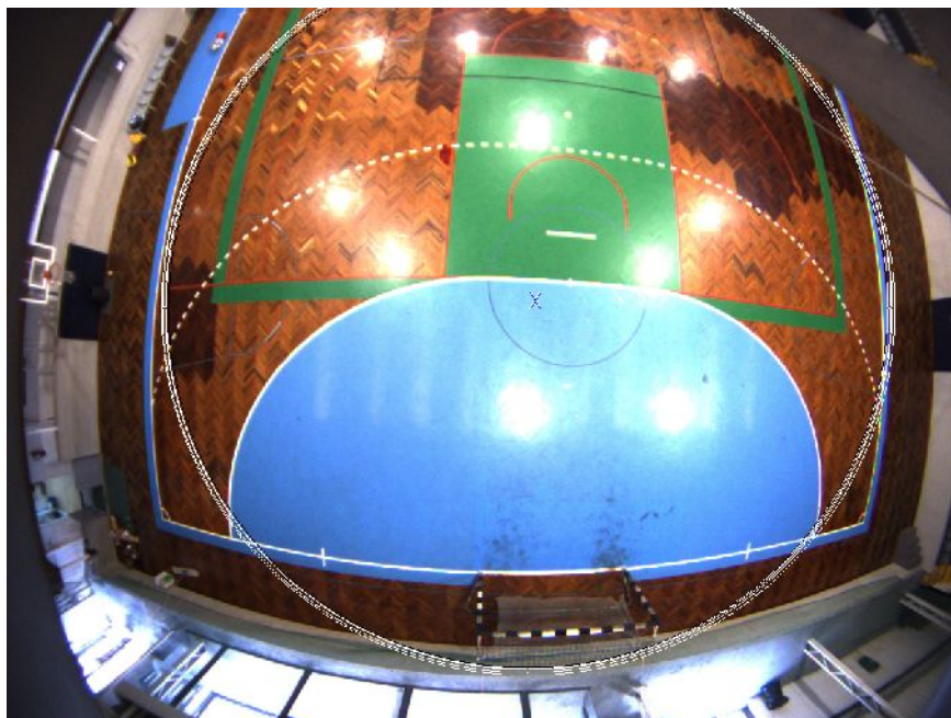
Figura 6.6 – Aproximação dum centro de lente com bons parametros intrinsecos
