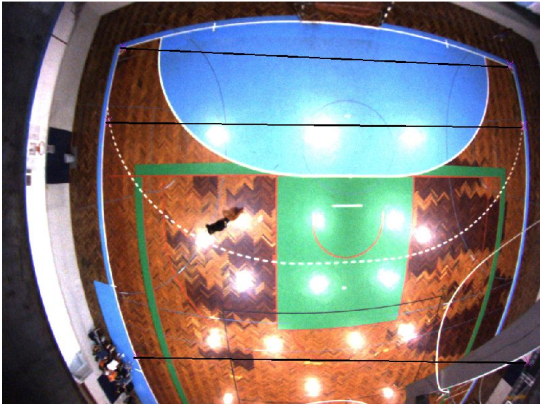
Figuras 5.9 – Aplicação de algoritmo varrimento em toda a imagem para a localização de pontos pertencentes às linhas laterais
