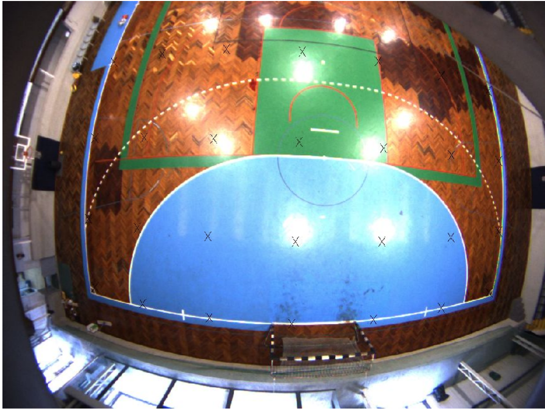
Figura 6.3 – Pontos respectivos de um padrão numa imagem distorcida
