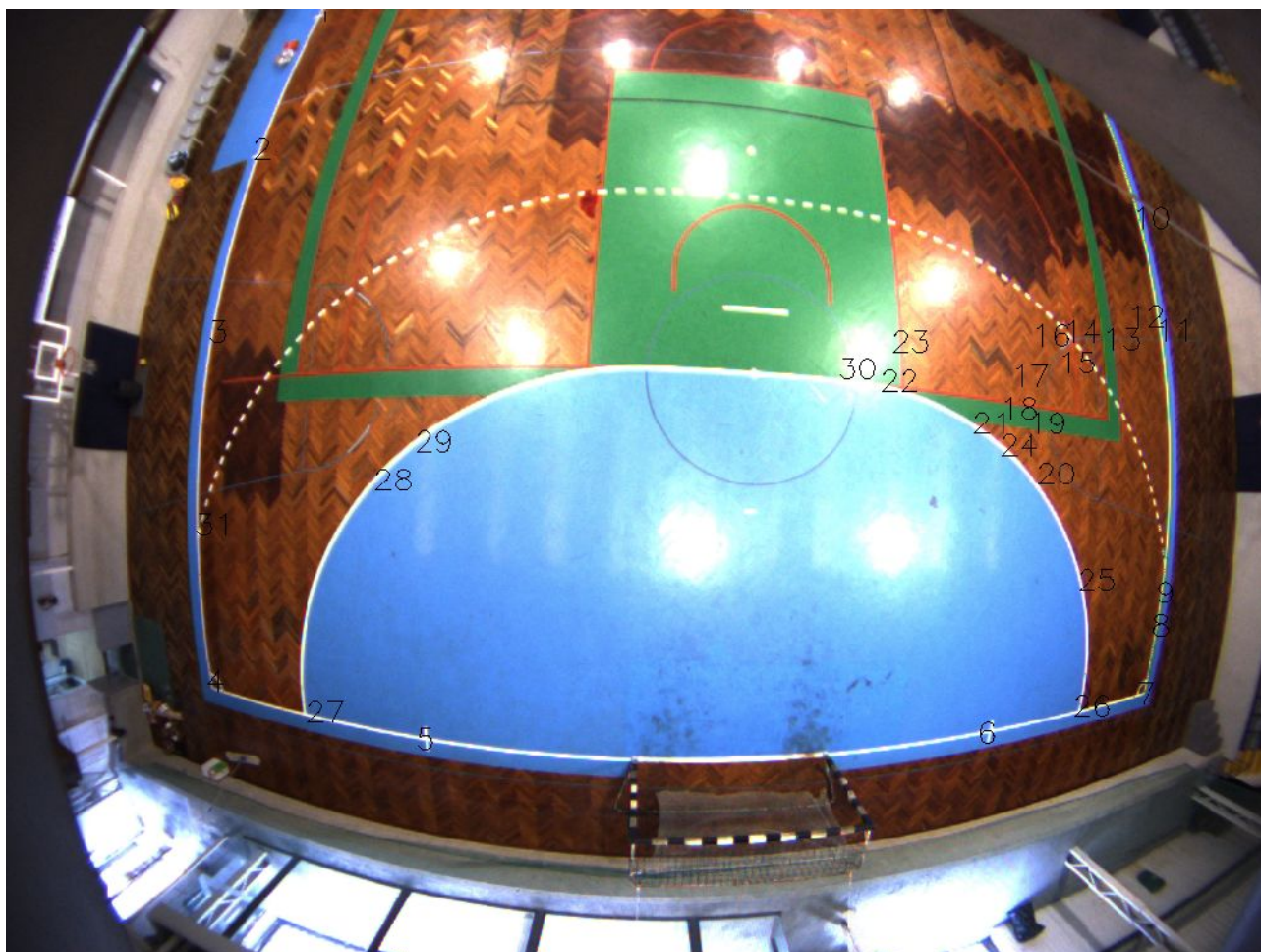
Figura 5.3 – Numeração de Pontos Obtidos através da função cvGoodFeaturesToTrack
